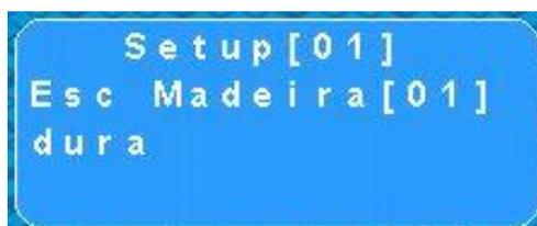
Após entrar na função, selecionar o setup desejado com as teclas (↑) e (↓). Para entrar no setup selecionado, teclar (E), com as teclas (↑), (↓), (←), (→) selecionar a opção desejada e teclar (E) para confirmar as alterações.
